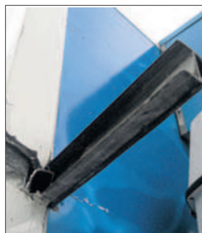
Diese Metallstrebe bohrte sich zwei Meter tief in die Thermohaut des Kühlwagens. Fotos: Polizei
